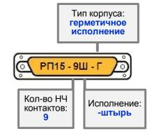
\* Метрический шаг НЧ контактов – 2,8 мм Розетка комплектуется металлическим кожухом по запросу потребителя
